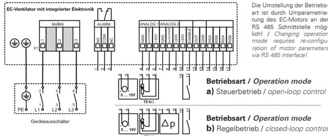
Die Umstellung der Betriebsart ist durch Umparametrierung des EC-Motors an der RS 485 Schnittstelle möglich! / Changing operation mode requires re-configuration of motor parameters via RS 485 interface!
