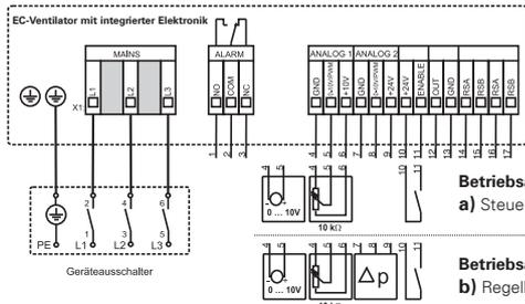
Die Umstellung der Betriebsart ist durch Umparametrierung des EC-Motors an der RS 485 Schnittstelle möglich! / Changing operation mode requires re-configuration of motor parameters via RS 485 interface!
