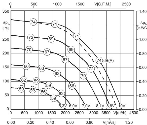
Lufteleistungskennlinie bei radialer Durchströmung / Air performance curve at radial air flow
