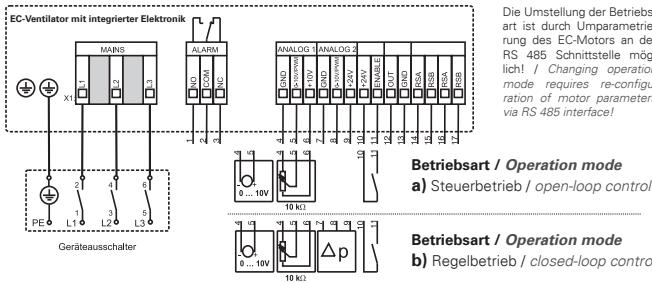
Die Umstellung der Betriebsart ist durch Umparametrierung des EC-Motors an der RS 485 Schnittstelle möglich! / Changing operation mode requires re-configuration of motor parameters via RS 485 interface!
