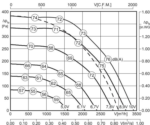
Lufteleistungskennlinie bei radikal Durchströmung / Air performance curve at radial air flow
