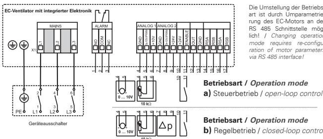
Die Umstellung der Betriebsart ist durch Umparametrierung des EC-Motors an der RS 485 Schnittstelle möglich!
