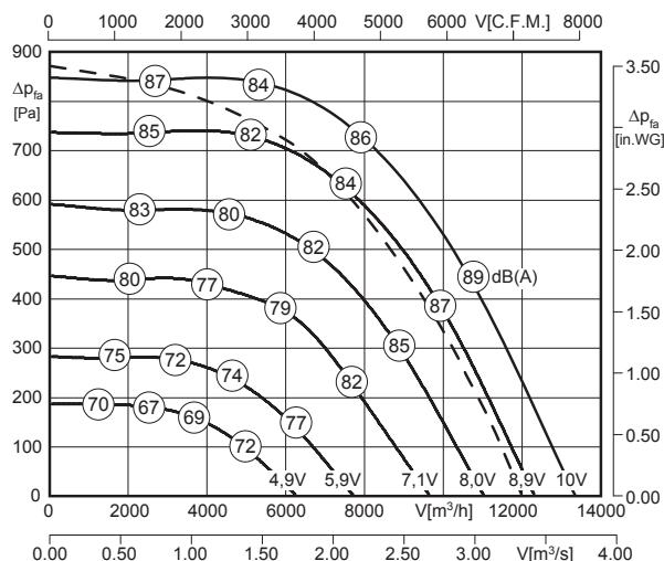
Luftleistungskennlinie bei radialer Durchströmung / Air performance curve at radial air flow
